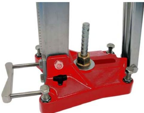
Таким же образом станину можно закрепить на стене или на потолке. В этом случае следует учесть, что анкерное крепление, кроме силы противодействия нажиму коронки, должно еще выдерживать нагрузку от массы станины, бормотора и алмазной коронки, которая, возможно, будет наполнена водой.
