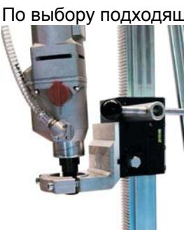
Для установки бормотора на каретке станины Leonardo-180 предусмотрен хомут Ø60 мм. Установите шейку бормотора в хомут и затяните фиксирующие болты.
