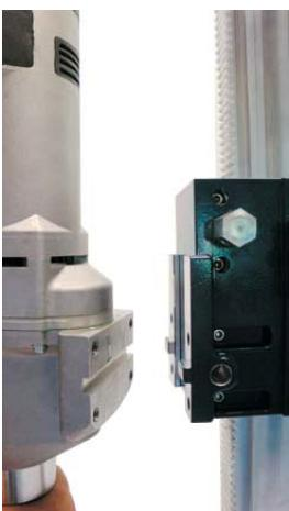
Если корпус бормотора имеет монтажную площадку, то штатный хомут станины можно демонтировать, а бормотор привинтить 4-мя болтами M8 непосредственно к каретке станины.
